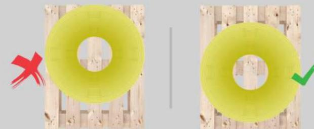
Posizionare la coils al centro del pallet. La larghezza del pallet dovrebbe essere adatta per l'allineamento della coils al centro correttamente.
